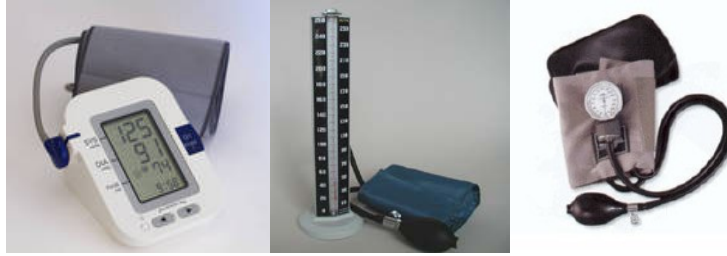
شکل ۲: انواع دستگاه های فشارسنج (عقربه ای، جیوه ای و دیجیتال)
